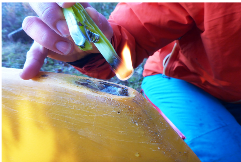
Sen smälte jag en snodd klädnypa för att tätä
