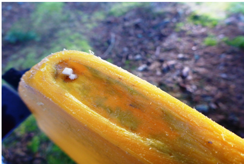
Lagningen började med att trycka i trästickor i de två små hålen
