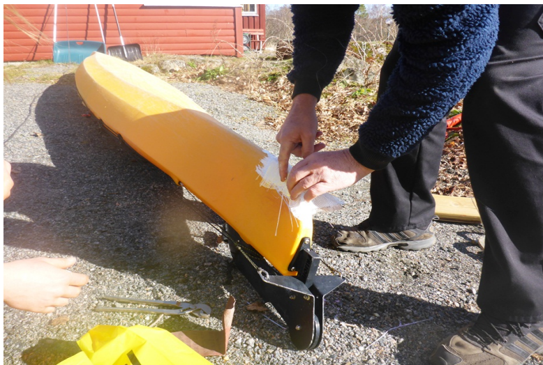
Lagning med silikon och glasfiberväv
